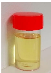
Figure IV.14 : Solution finale de dépôt de CZTS
