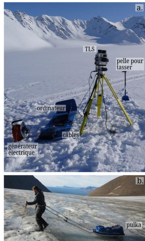
Figure 58 : (a) Installation du matériel nécessaire au fonctionnement du TLS (photo S. Schiavone, avril 2015). (b) En été, le matériel se transporte en pulka (photo F. Tolle, août 2013)
