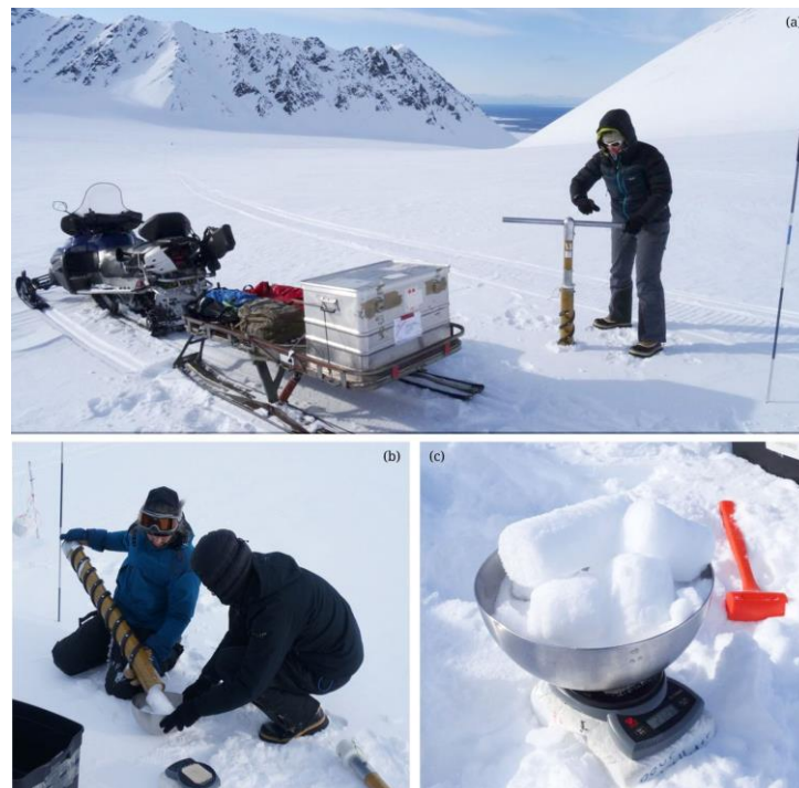
Figure 47 : Prélèvement d'une carotte de neige à la balise B26 (a). Après l'avoir transvasée dans un bol en acier (b), il faut peser la colonne de neige (c) sur place à l'aide d'une balance de précision et résistante au froid. Les calculs de densité se font ultérieurement, une fois de retour à la base Corbel (photos : S. Schiavone, avril 2015).
