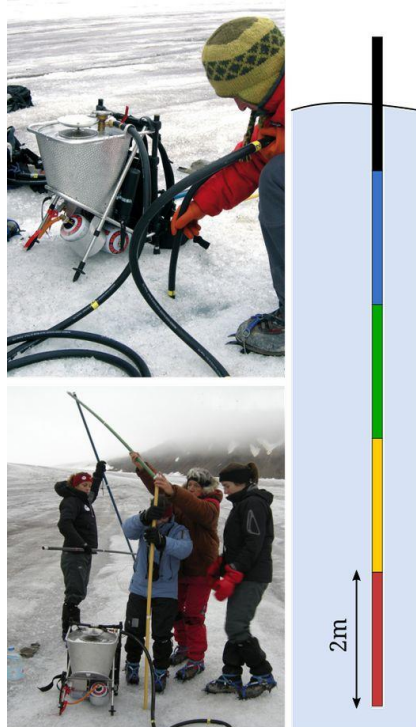
Figure 49 : Implantation d'une balise à glace à l'aide d'une foreuse à vapeur. Les balises de 10 m sont constituées de 5 jalons de 2 m reliés entre eux, suivant un ordre très précis identique en chaque point. Ce code couleur utilisé depuis L. Lliboutry facilite la lecture et l'évaluation de la quantité de glace perdue ou gagnée d'une année sur l'autre (photos : M. Griselin, juillet 2007)
