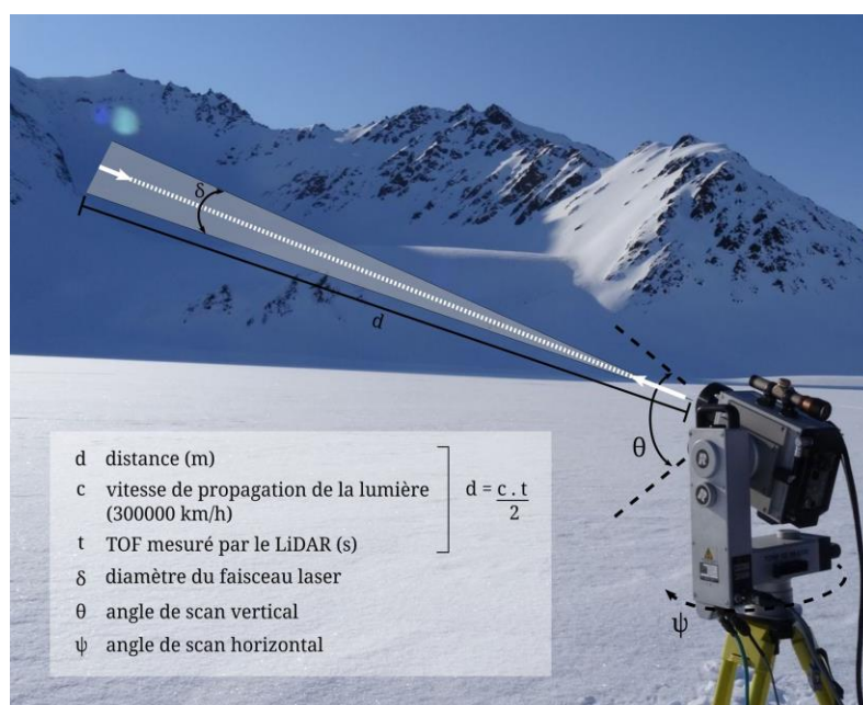
Figure 54 : Principes de mesure d'un LiDAR terrestre. Le faisceau laser émis par le LiDAR est renvoyé dès qu'il atteint une surface (ici le versant). La distance ( d ) du point atteint est calculée à partir du temps de parcours du faisceau mesuré par le LiDAR ( t ). Il est à noter que la mesure est très légèrement influencée par le diamètre du faisceau qui a tendance à augmenter avec la distance. L'instrument rotatif et le miroir oscillant permettent un scan vertical et horizontal de la zone d'intérêt (adapté de Prokop, 2008 ; photo : S. Schiavone, avril 2015).
