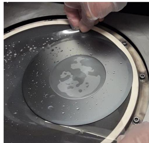
**Figure 104.** *Photographie du wafer de silicium à l'issue du rodage. Le wafer, déposé sur film plastique, est ici présenté sur l'appareil de Taiko process. La face arrière a été affinée de 700  $\mu\text{m}$  à 60  $\mu\text{m}$  d'épaisseur jusqu'à déboucher sur la couche de silicium poreux, visible sous forme d'un disque au centre de la plaque.*
