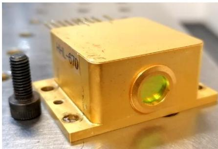
**Figure 24. Photographie d'un packaging HHL (High heat load) pour QCL.** La fenêtre laser apparaît en face avant, tandis que les broches d'alimentation sont visibles à l'arrière du boîtier. La chaleur produite par le QCL est généralement évacuée par un radiateur ou un refroidisseur Peltier couplé avec un ventilateur (non présenté ici). La vis placée à gauche de l'image pour référence mesure 1.7 cm de hauteur.
