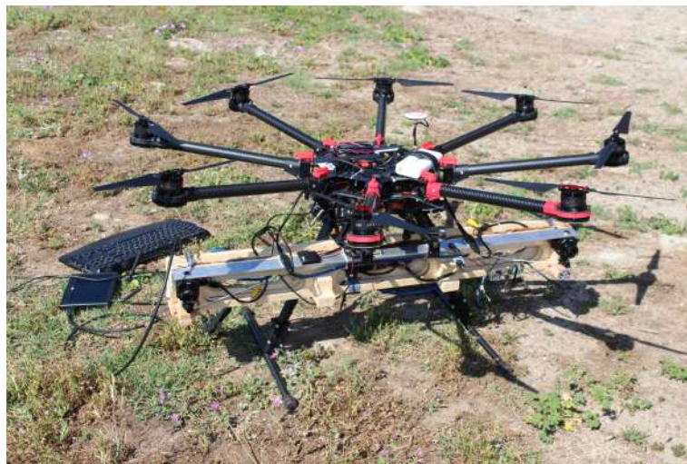
Figure 8.13: Dispositif de stéréovision multimodale complet avant un vol.
