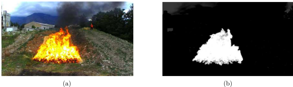
Figure 8.15: Exemple d'images de feu obtenues simultanément dans le spectre du visible et du spectre LWIR. (a) Image acquise dans le visible, (b) Image acquise dans le spectre LWIR.
