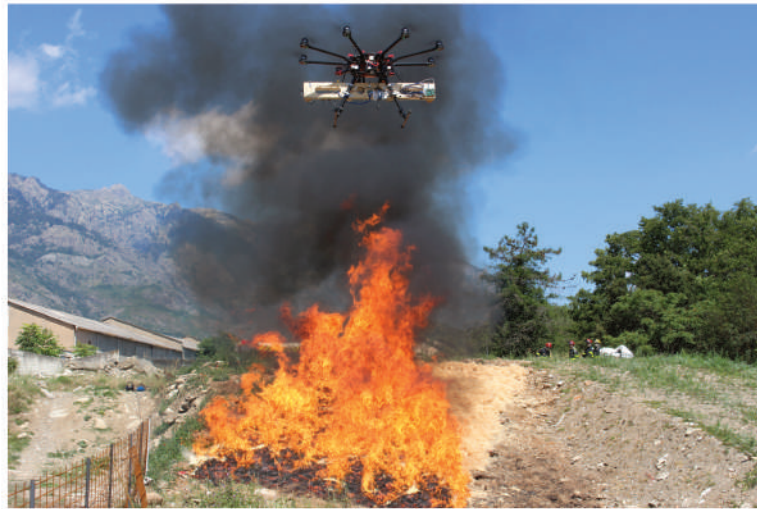
Figure 8.3: Système de vision porté par le drone DJI S1000 situé approximativement à 12 m à l'arrière d'un feu.
