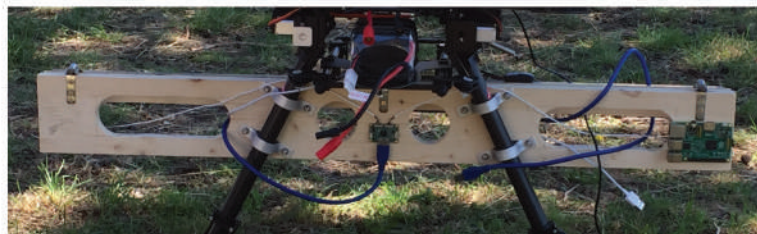
Figure 8.7: Système permettant d'attacher le dispositif de vision sur le drone.
