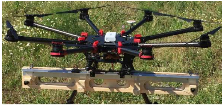
Figure 8.2: Module de stéréovision composé de caméras du visible monté sur le drone DJI S1000.
