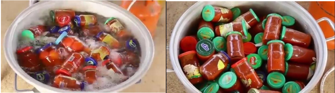
Photo 8 : Etape de pasteurisation de la purée
