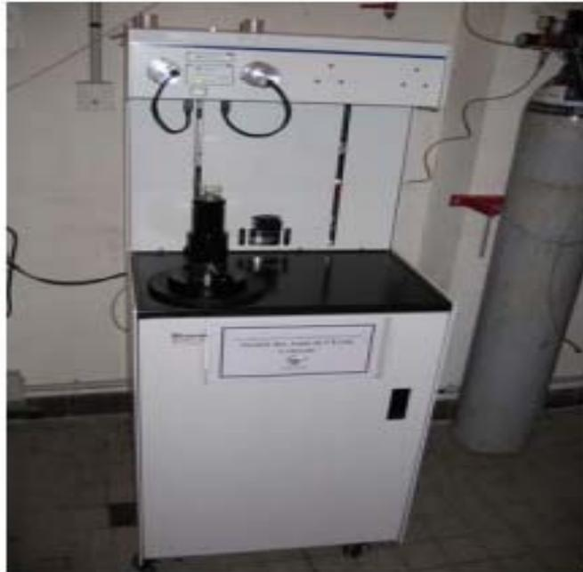
Figure II.7. Photo du porosimètre Micromeritics Auto pore IV
