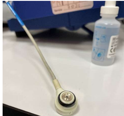
Illustration 4 : Moniteur de TCPO2 et électrode Clark.
