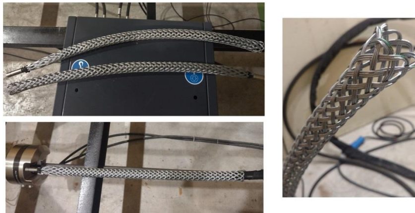
Figure 6.20: Chaussette métallique utilisée pour la prise des éprouvettes.
