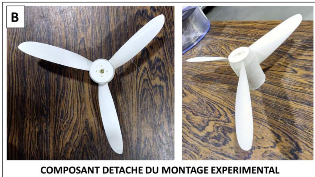
Figure 202 : fabrication additive de pièces en polymère fondu de grandes dimensions, résultat obtenu suite à la fabrication de l'hélice
