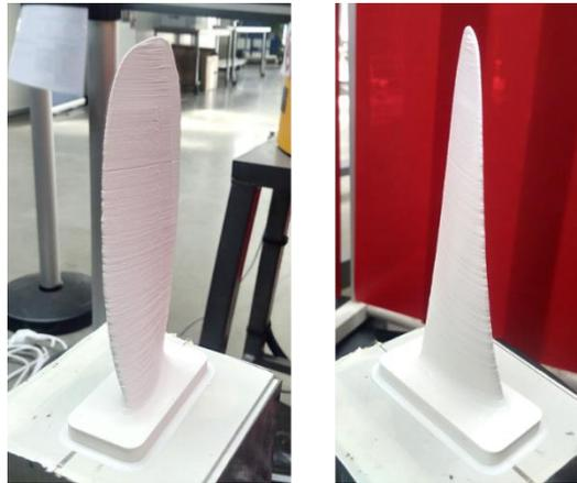
Figure 119 : fabrication additive de pièces en polymère fondu de grandes dimensions, pales bâties par la stratégie volumique
