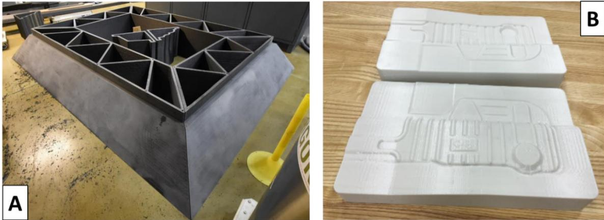
Figure 8 : fabrication additive de pièces en polymère fondu de grandes dimensions, coffrages en béton et outils de formage et à froid et d'hydroformage
