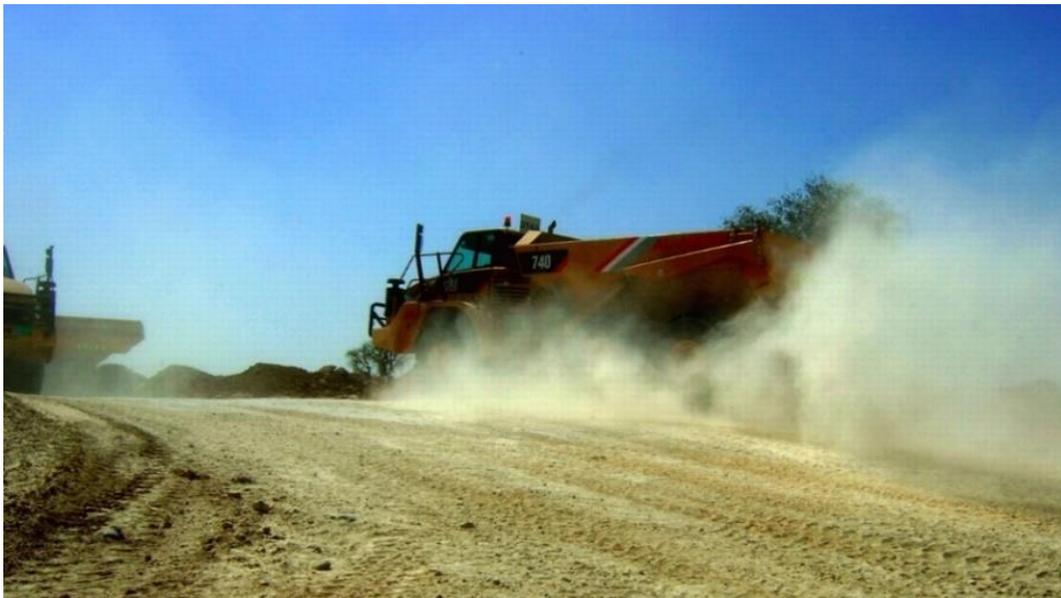
**Figure 0-2 : Poussière générée par la circulation d'un tombereau articulé sur un chantier de terrassement (Walker, 2012)**
