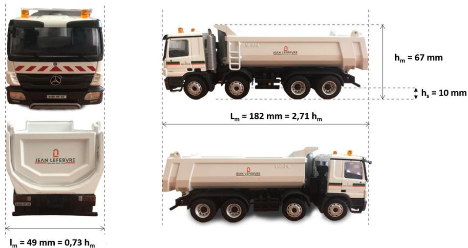
Figure 4-6 : Maquette échelle 1/50 de camion Mercedes 8x4 (adapté de Duran-Garcia, 2020)
