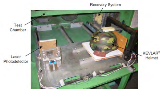
FIGURE 1.5 – Étude de résistance à l'impact d'un casque de protection militaire [13]
