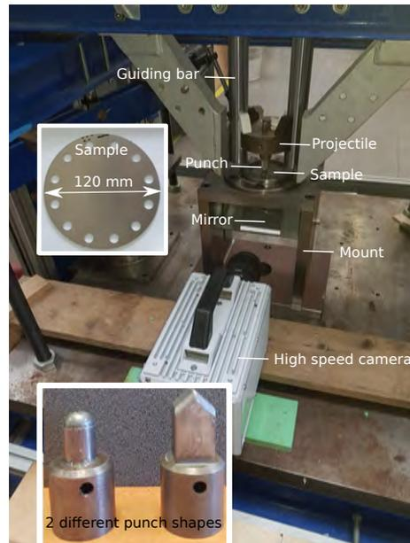
FIGURE 4.1 – Dispositif catapulte du laboratoire IRDL de Lorient
