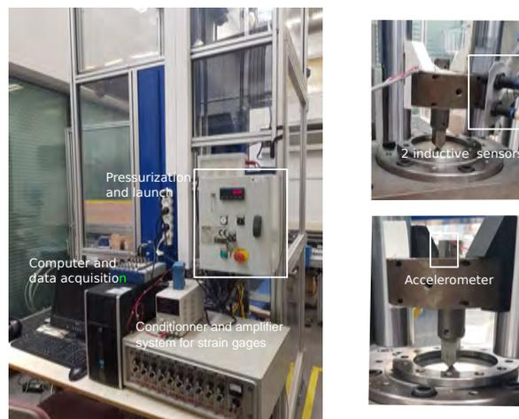
FIGURE 4.2 – Système d'acquisition des essais d'impacts
