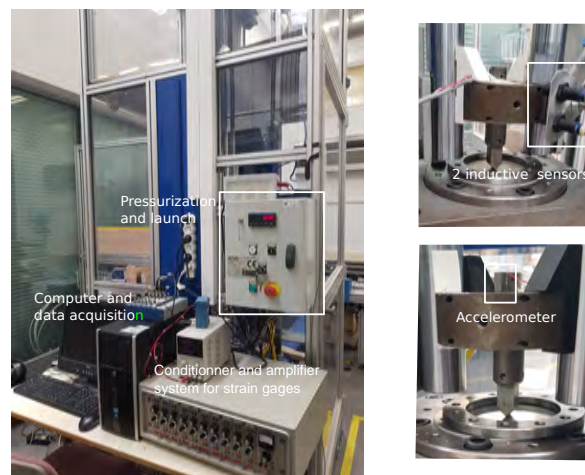
FIGURE 4.2 – Système d'acquisition des essais d'impacts
