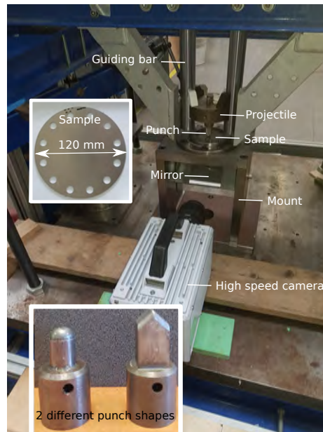
FIGURE 4.1 – Dispositif catapulte du laboratoire IRDL de Lorient
