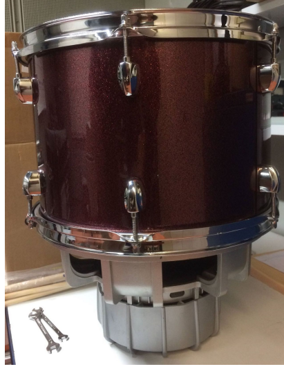
FIGURE 9.2 – Système constitué d'un tom avec un haut-parleur
