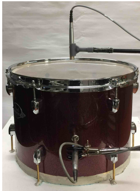
FIGURE 10.38 – Microphone au-dessus de la membrane qui sera utilisé pour évaluer l'effet du contrôle au point milieu de la membrane, en outre du microphone dans la cavité utilisé comme capteur dans la boucle de contrôle.
