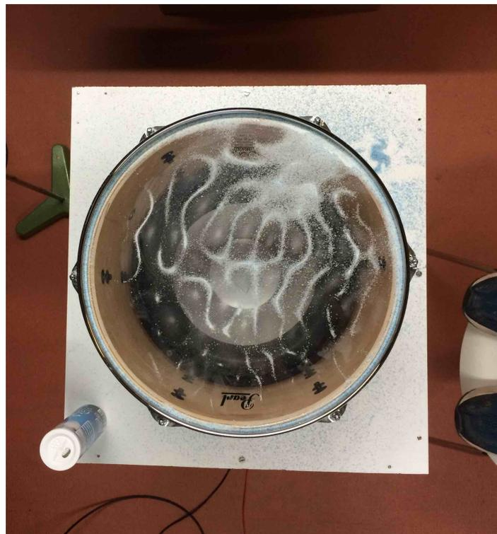
FIGURE D.10 – Figure de Chladni à 792Hz
