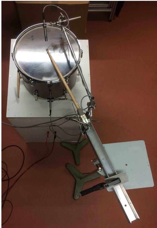
FIGURE 10.40 – Support-baguettes monté dans le dispositif expérimental dans le but d’obtenir une frappe reproductible au milieu de la membrane
