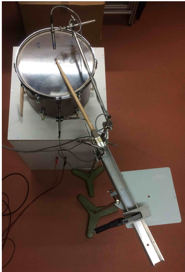
FIGURE 10.40 – Support-baguettes monté dans le dispositif expérimental dans le but d’obtenir une frappe reproductible au milieu de la membrane
