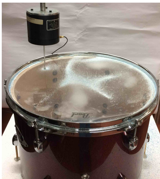
FIGURE 10.24 – Dispositif pour les figures de Chladni (excitation par un pot vibrant externe) : le pot vibrant et la membrane vibrant selon le mode 21.
