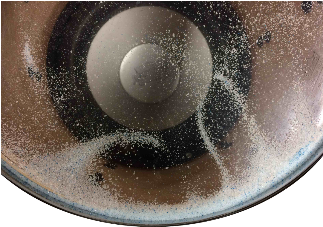
FIGURE D.9 – Détail de la figure de Chladni à 275Hz
