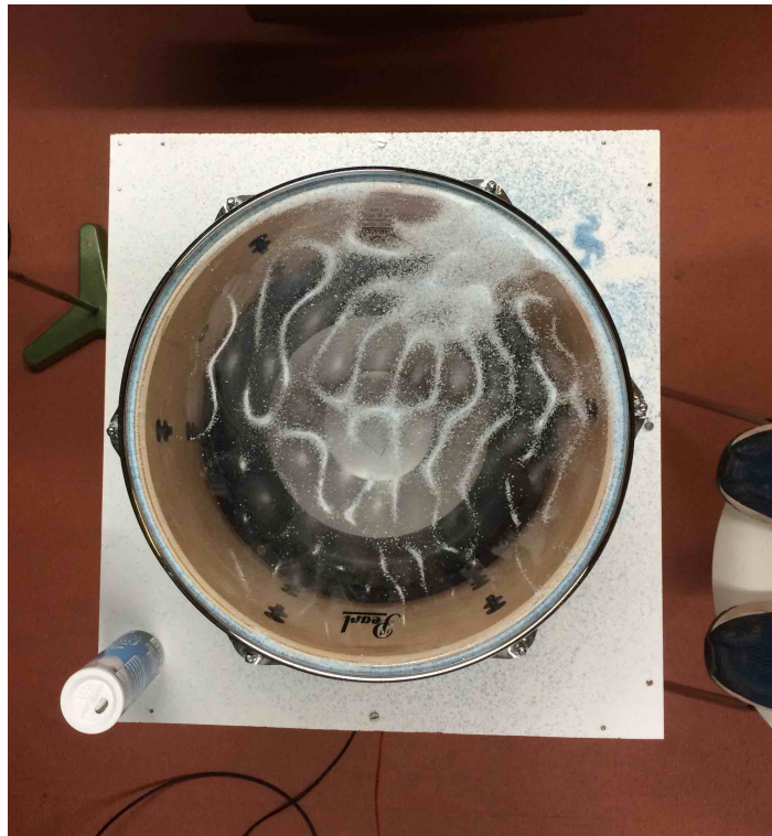
FIGURE D.10 – Figure de Chladni à 792Hz
