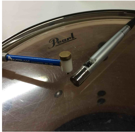
FIGURE 10.16 – Dispositif d'accordage de la membrane : marteau d'impact et microphone
