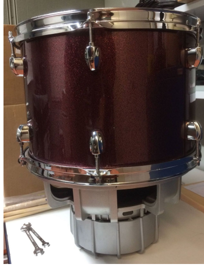
FIGURE 9.2 – Système constitué d'un tom avec un haut-parleur
