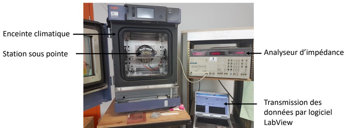
Figure 97. Photo de l'appareillage de mesure.
