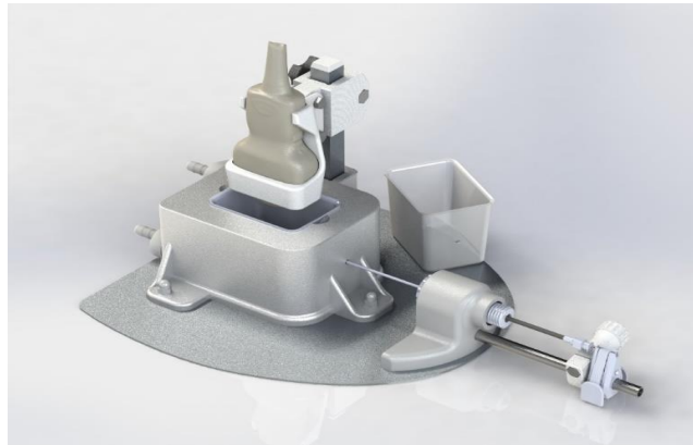
Figure 2.1 : Dispositif de réchauffement et maintien au chaud pour les traitements expérimentaux ex vivo
