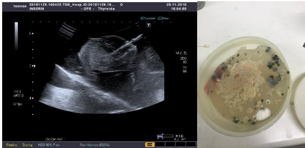
Figure 3.4 : Visualisation échographique du tissu de dinde à travers l'agar agar et aspect du modèle au bout de 21 jours avec conservation à 4°C
