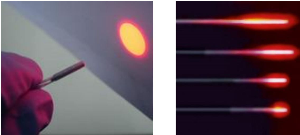
Figure 1.5 : Fibre à tir direct à gauche et fibres diffusantes à droite
