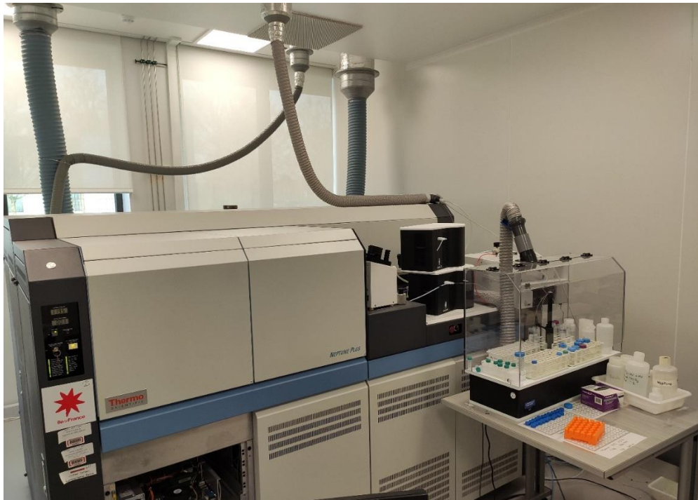
Photo 4 : Spectromètre de masse à multi-collection Neptuneplus du LSCE
