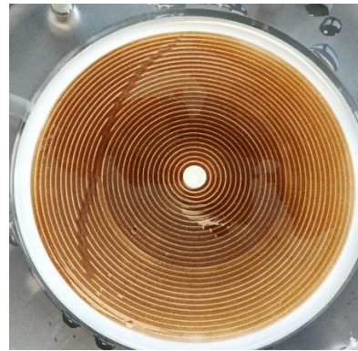
Photo 2 : système de filtration des oxydes de manganèse (gauche) et un filtre avec les oxydes fixés dessus après filtration (droite)
