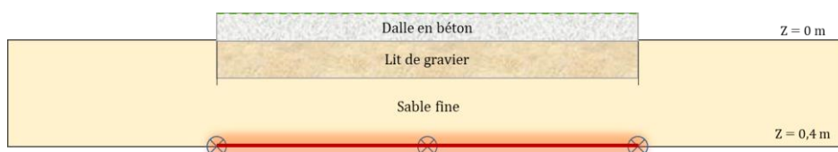
Figure 2.7. Schéma conceptuel du site expérimentale SCERES – Source continue.
