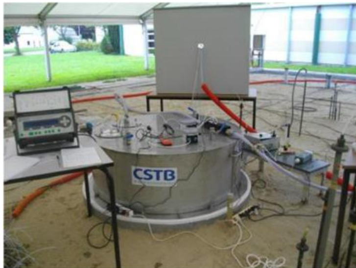
Figure 2.5. Chambre expérimentale installée sur le bassin SCERES [141].
