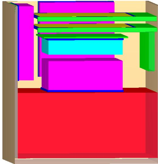
FIGURE 5.3 – Rendu 3D de l’instrument avec détecteurs latéraux. Par rapport à l’instrument avec scintillateur plastique, on a ajouté deux détecteurs latéraux en  $\text{CeBr}_3$  (en magenta) lus par des SiPMs (bleu) montés sur des cartes électroniques de support (vertes).
