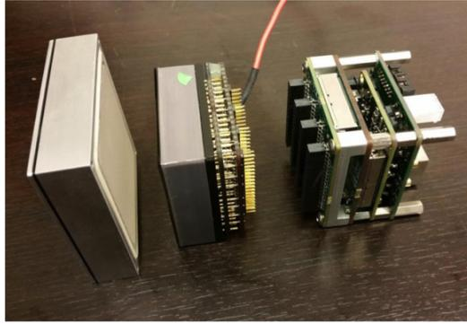
FIGURE 3.1 – Photographie des composants d'un module calorimètre démonté. De gauche à droite : le cristal de  $\text{CeBr}_3$  dans son boîtier étanche, le tube photomultiplicateur multi-anode (MAPMT) et l'électronique de lecture ROSMAP. Le volume sensible au rayonnement gamma (le cristal) mesure  $51 \times 51 \times 10 \text{ mm}^3$
