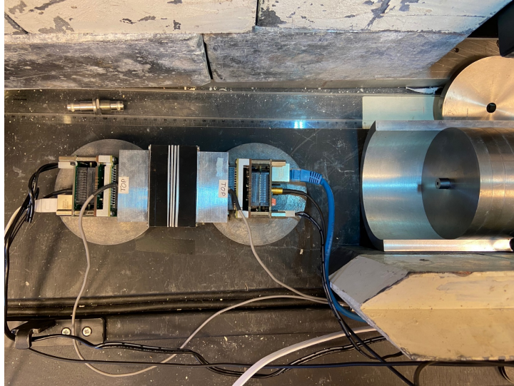
FIGURE A.6 – Photographie du dispositif utilisé pour les premiers tests de coïncidences. On peut voir collés face-à-face deux modules calorimètres, et sur la droite de l’image le collimateur contenant la source de ^{137}\text{Cs} .
