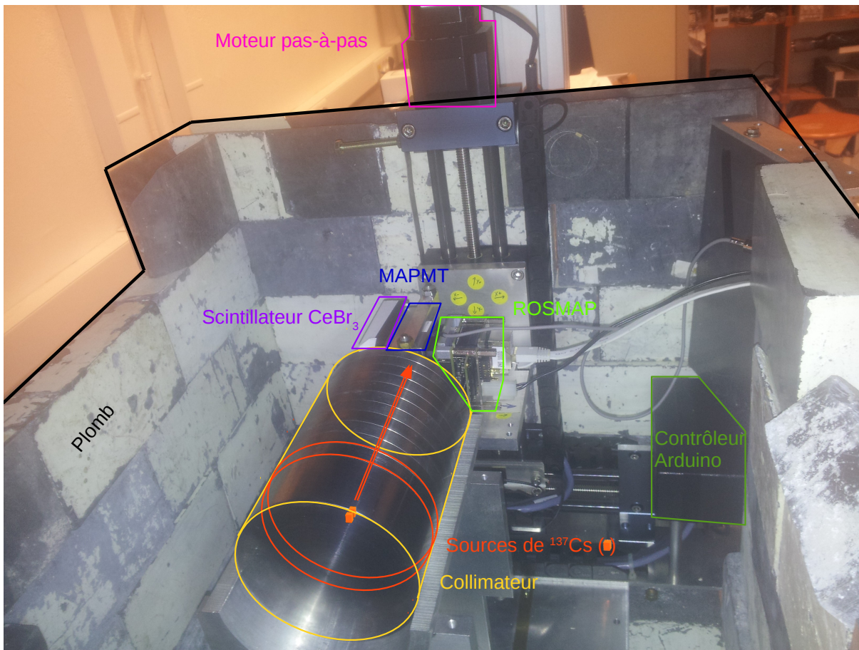
FIGURE 3.4 – Photographie légendée du banc de scan automatisé avec la source de ^{137}\text{Cs} et son collimateur. La source est encadrée en orange, le collimateur en jaune, le cristal de \text{CeBr}_3 , le MAPMT et le ROSMAP respectivement en violet, bleu et vert clair. Le boîtier de la carte Arduino est encadré en vert foncé et le moteur pas-à-pas responsable du mouvement en y en rose (celui en x est situé sous le boîtier et n'est donc pas visible sur cette photo). Le blindage en plomb, qui est constitué de briques blanches et grises, est entouré de noir.
