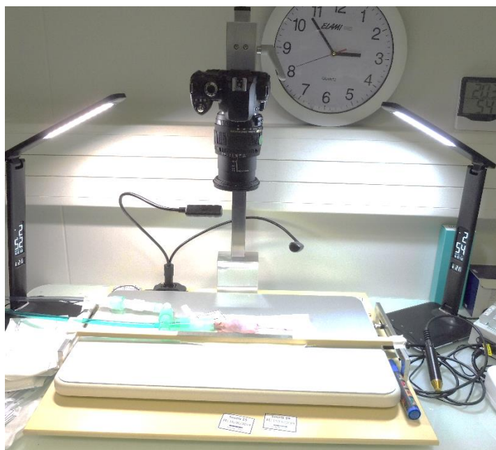
Figure 28 : Dispositif de prise de vue des lésions cutanées sur souris anesthésiées
