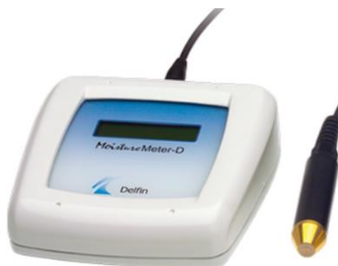
Figure 30 : MoistureMeterD (Delfin technologies®) équipé de la sonde permettant de mesurer l'hydratation cutanée chez la souris.
