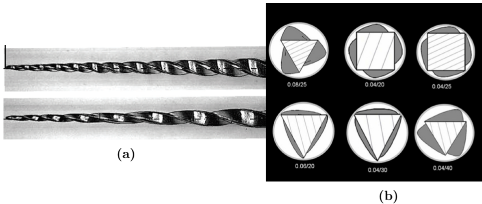
Figure 1.3 – Exemples (a) d'outils avec des pas différents sur l'arête de coupe et (b) de sections typiques utilisées pour les instruments endodontiques [Poggio+2015].
