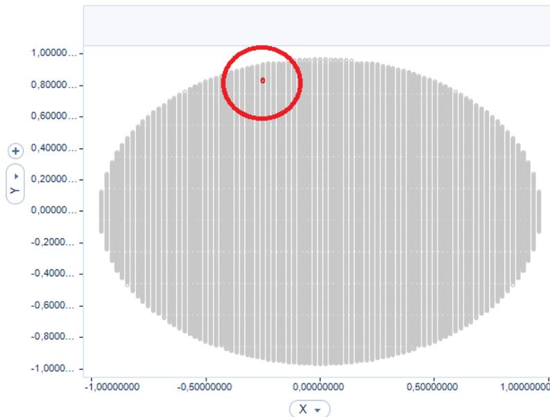
FIGURE 2.14 – Outlier spot sur le wafer
