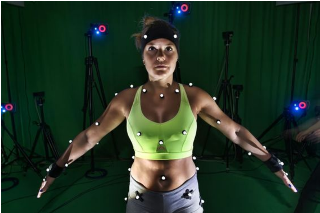
FIGURE 1.16 – Capture du mouvement via un système optoélectronique avec marqueurs passifs
