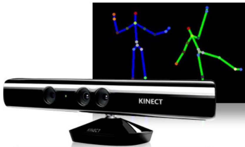
FIGURE 1.15 – Caméra Microsoft Kinect pour la capture du mouvement dans le domaine du jeu vidéo
