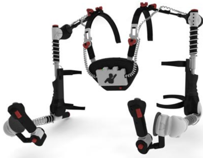
FIGURE 1.17 – Capture du mouvement mécanique grâce au Gypsy 7 Torso permettant la capture des mouvements du haut du corps
