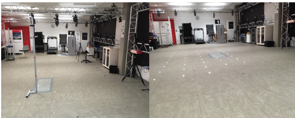
FIGURE 2.2 – Photo du dispositif expérimental avec la baguette de calibration fixée au mât, les caméras Vicon, le Mokam et les positions repérées au sol
