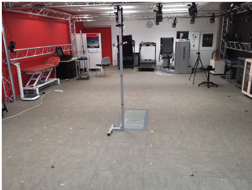
FIGURE 2.5 – Baguette avec contraste faible sur le mât vertical avec les différentes hauteurs marquées en rouge allant du raz du sol à 2 m par palier de 0,5 m
