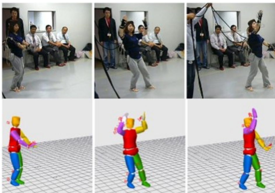
FIGURE 1.18 – Exemple de système de capture du mouvement magnétique
