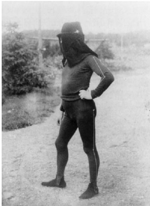
FIGURE 1.5 – Costume de MoCap constitué de points et de lignes représentant les articulations et segments corporels (Marey 1884)
