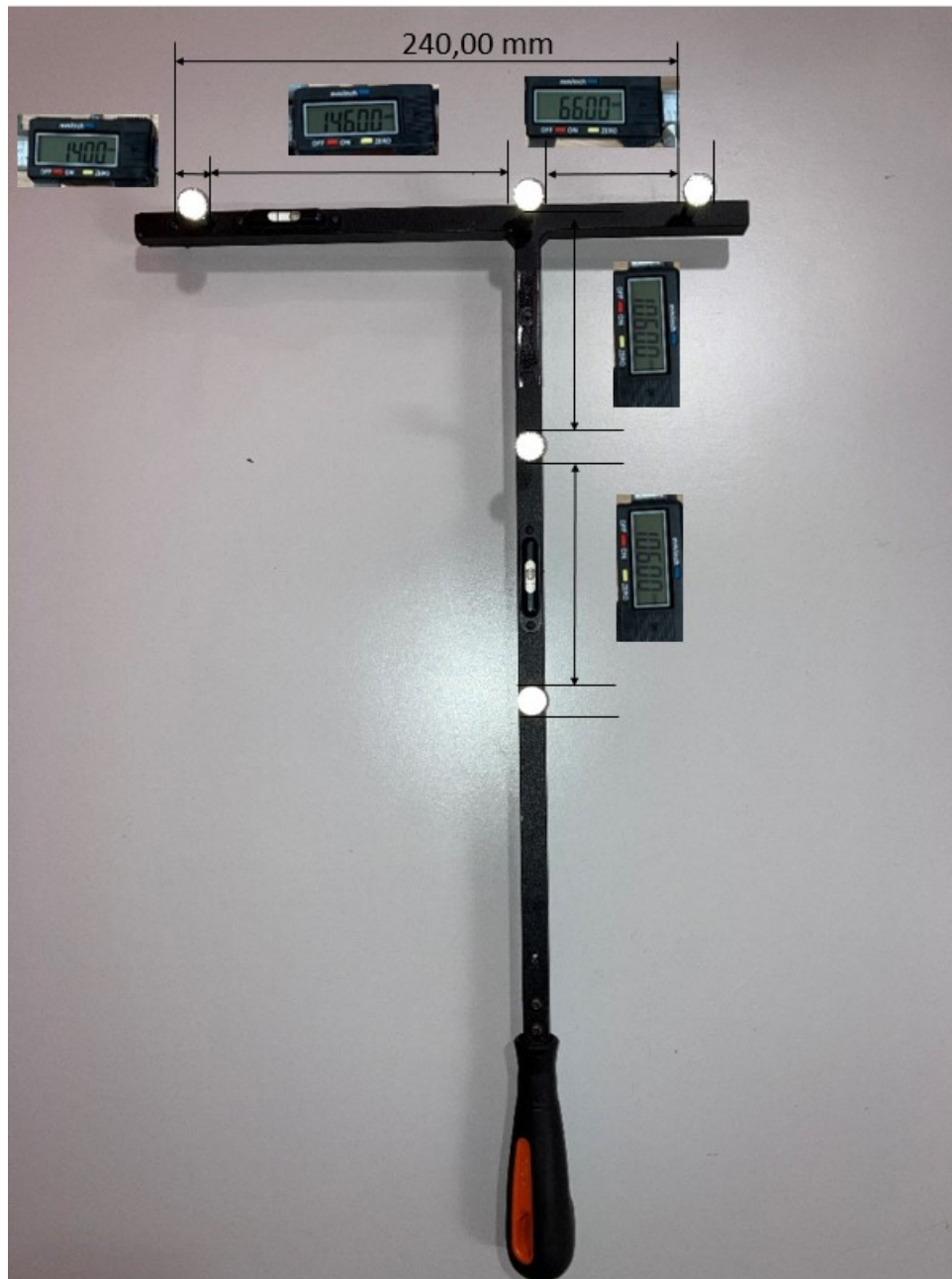
FIGURE 1.25 – Baguette de calibration du système Vicon avec les longueurs en millimètre entre les marqueurs
