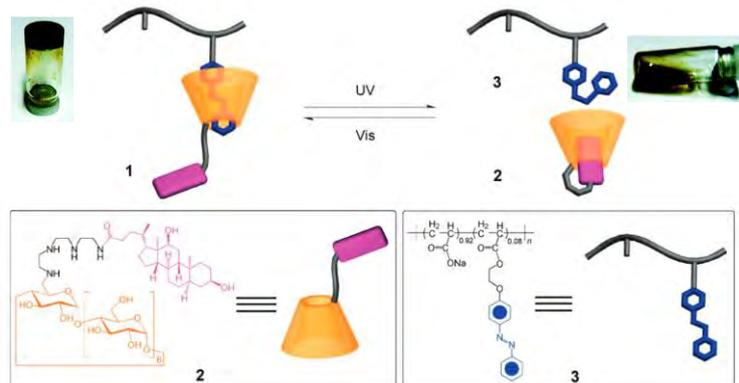
Figure 44: Complexe d'inclusion supramoléculaire 1 formé d'un dérivé de  $\beta$ -CD-Désoxycholate 2 et d'un copolymère PAA-AZO 3. Le complexe 1 peut former, en solution aqueuse, un hydrogel disposant d'une transition sol-gel induite par l'isomérisation photo-stimulable de l'unité AZO. Reproduit depuis Zhao *et coll.*<sup>161</sup>
