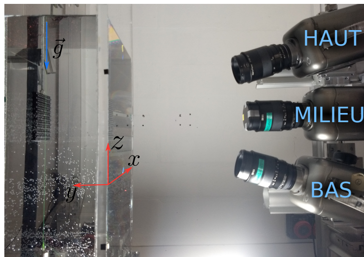
Figure II.11 – Photographie du positionnement des caméras : celle du milieu est équipée d'un filtre de couleur filtrant notamment la lumière verte. La verticale est réglée grâce à un fil à plomb suspendu au moment de la calibration. Les trois caméras seront notées H (HAUT), M (MILIEU) et B (BAS) par la suite.
