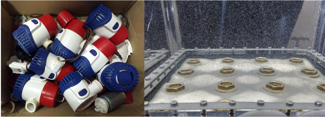
Figure IV.24 – Cadavres des pompes défailantes ( gauche ) ; la neige de particules en polystyrène après l'extinction de toutes les pompes a donné son nom au dispositif : « Tour à Neige (Marine) » ( droite ).
