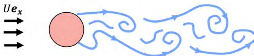
FIGURE 11 – Représentation schématique de l'instabilité de sillage derrière un cylindre.
