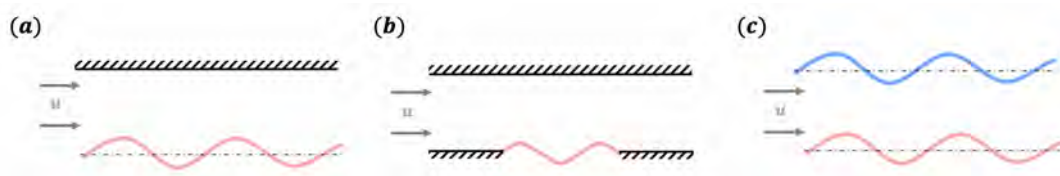
FIGURE 14 – Illustrations des configurations visées dans le chapitre 1 (a) membrane infinie confinée (b) membrane proche d'une surface libre (c) membrane finie confinée.
