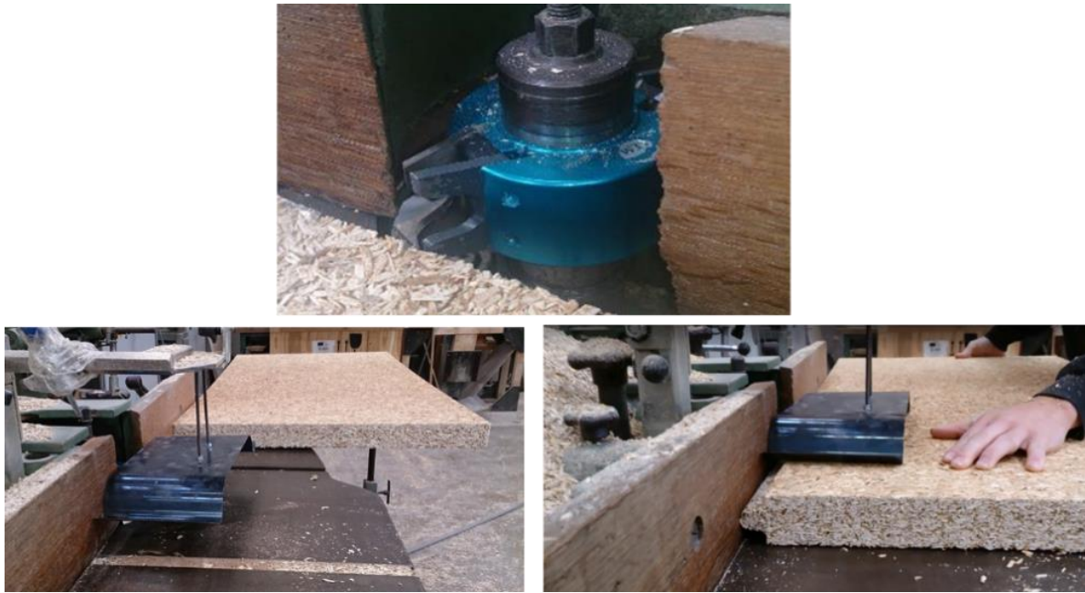
Figure V-15 : Usinage des panneaux pour la réalisation des profils rainures et languettes
