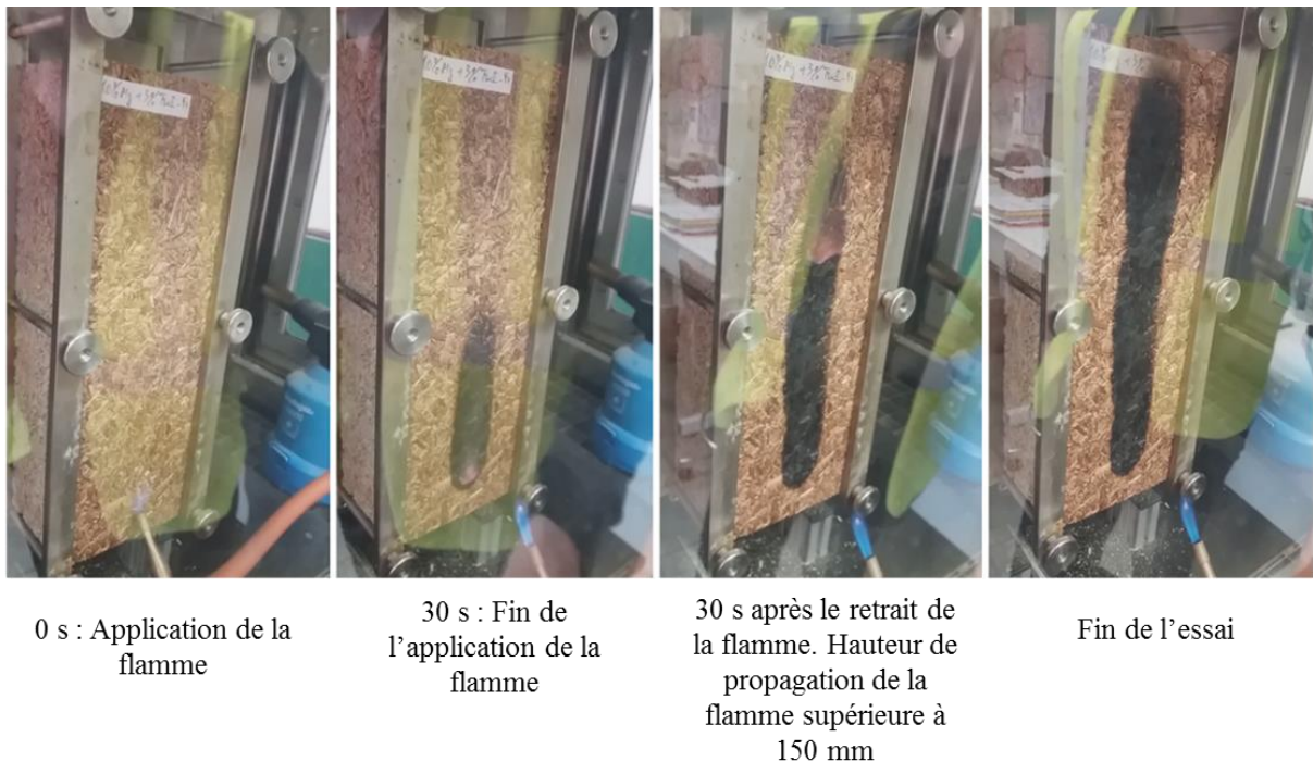
Figure VI-6 : Propagation de la flamme observée sur l'échantillon traité avec 3% de particules de silice fonctionnalisées et 10% de sulfate de magnésium heptahydraté (Ech F 3PSF-10SMH)
