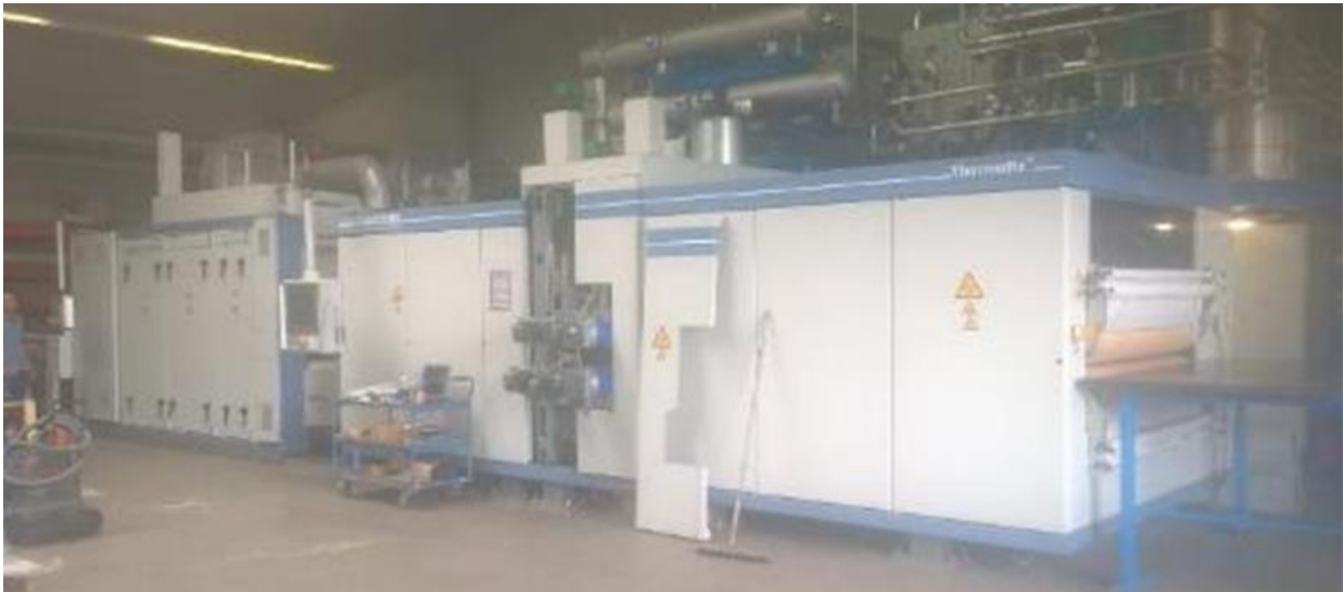
Figure V-3 : Ligne pilote utilisée pour tester la fabrication en continu du panneau rigide de chènevotte.
