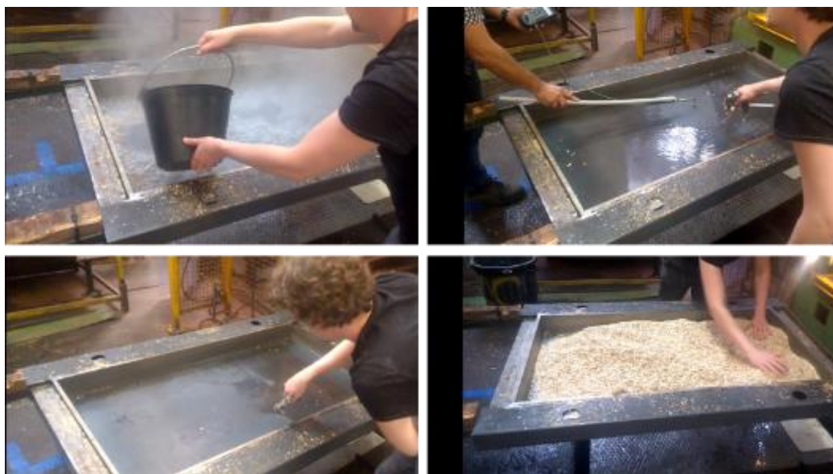
Figure V-17 : Etape de refroidissement du moule avant conformation du mat
