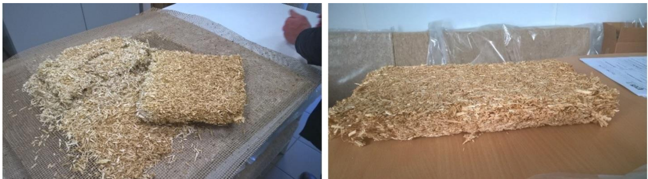
Figure IV-6: Composites Chènevotte/Acrodur® fabriqués à l'aide du four industriel de Cavac.
