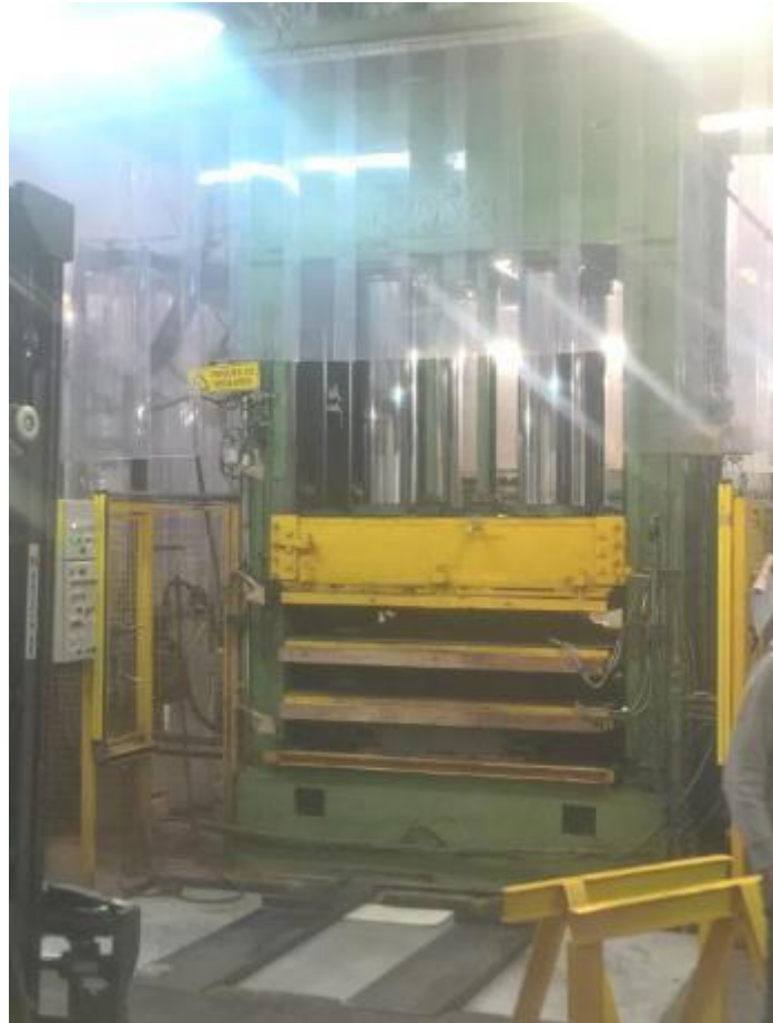
Figure V-10 : Thermopresse industrielle utilisée pour le prototypage des panneaux rigides isolants de chènevotte
