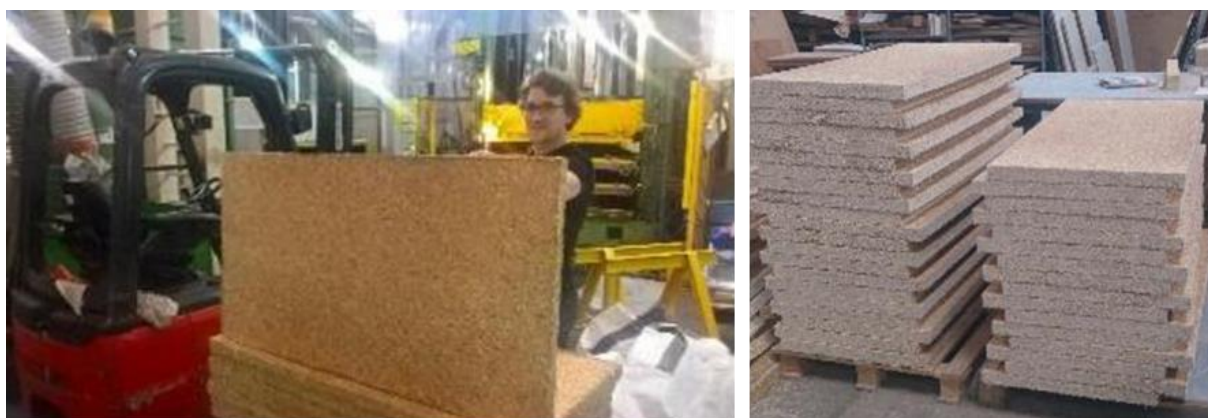
Figure V-14 : Panneaux isolants rigides de chènevotte de dimension 1.3 m x 0.7 m x 0.05 m
