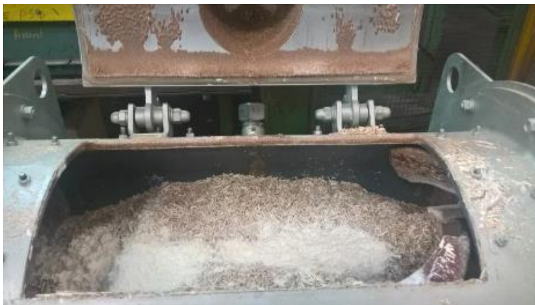
Figure V-12 : Introduction de la chènevotte avec la matrice biosourcée dans le mélangeur
