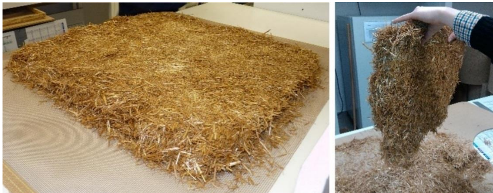
Figure IV-5 : Panneaux de paille après traitement thermique
