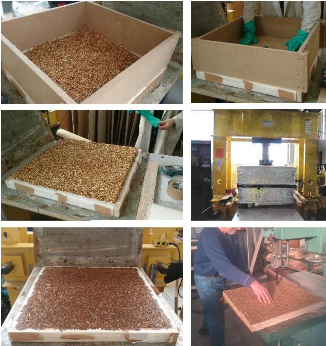
Figure IV-8 : Etapes de fabrication des panneaux par thermopressage (formation du mat, pre pressage, pressage à chaud et découpe des panneaux)
