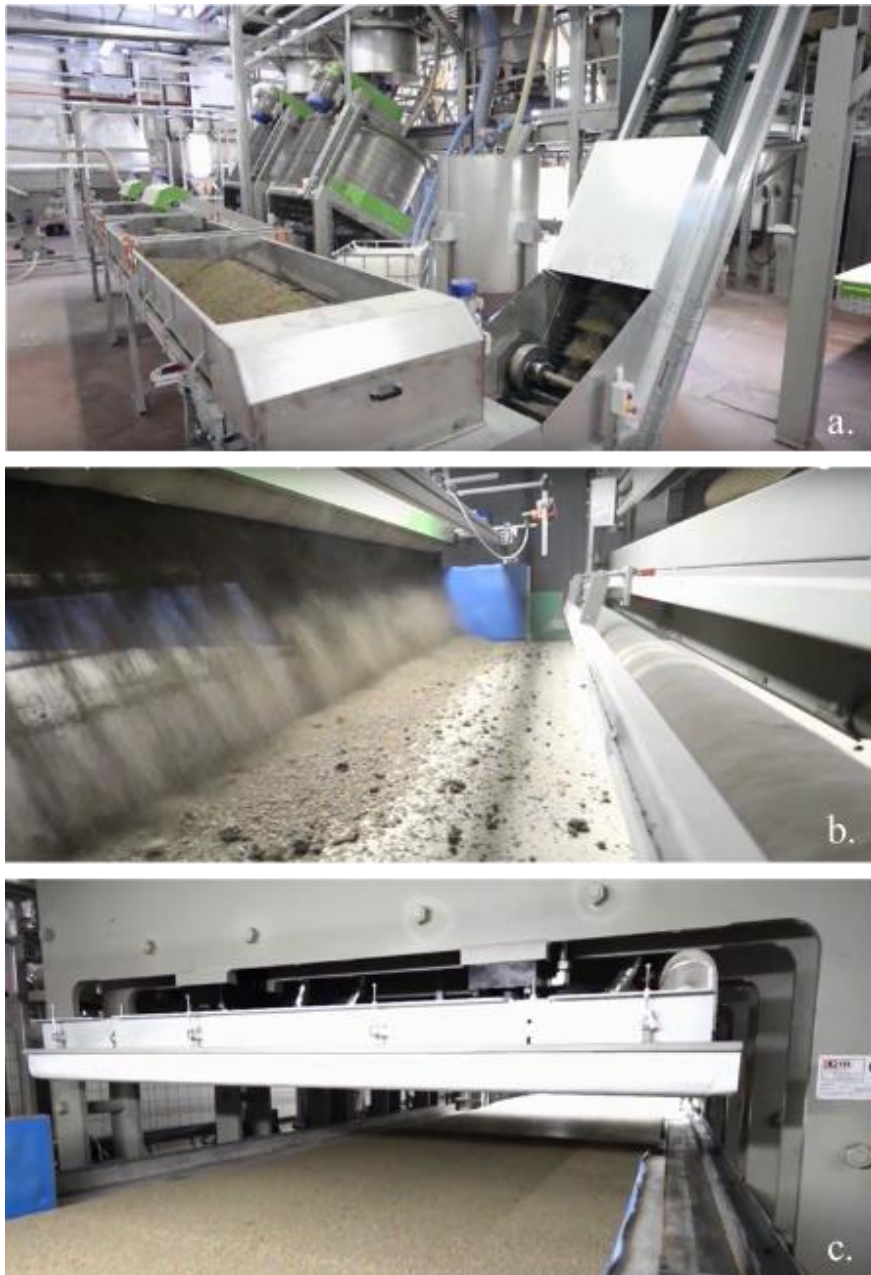
Figure V-20 : Ligne industrielle utilisée pour la production des panneaux rigides de chènevotte. Source des images : (CMF Greentech, 2016)
