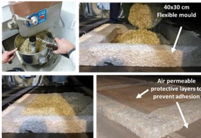
Figure IV-3 : Mélange liant granulats et conformation du mat sur la bande de convoyage
