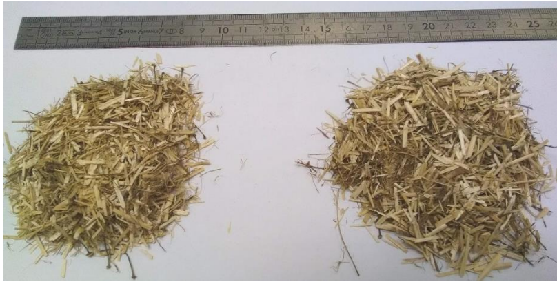
Figure II-27 : Anas de lin calibré avec les grilles G7 à gauche et G14 à droite
