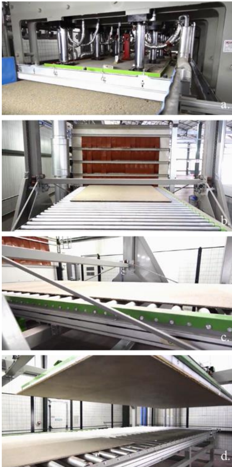
Figure V-21 : Ligne industrielle utilisée pour la production des panneaux rigides de chènevotte (suite). Source des images : (CMF Greentech, 2016)
