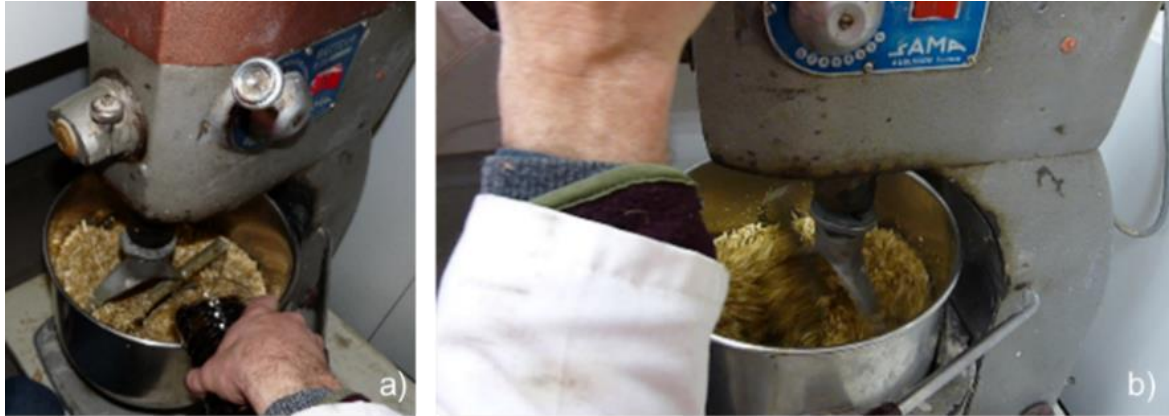
Figure VI-1 : Mélangeur de laboratoire SAMA utilisé pour l'application des traitements sur la chènevotte
