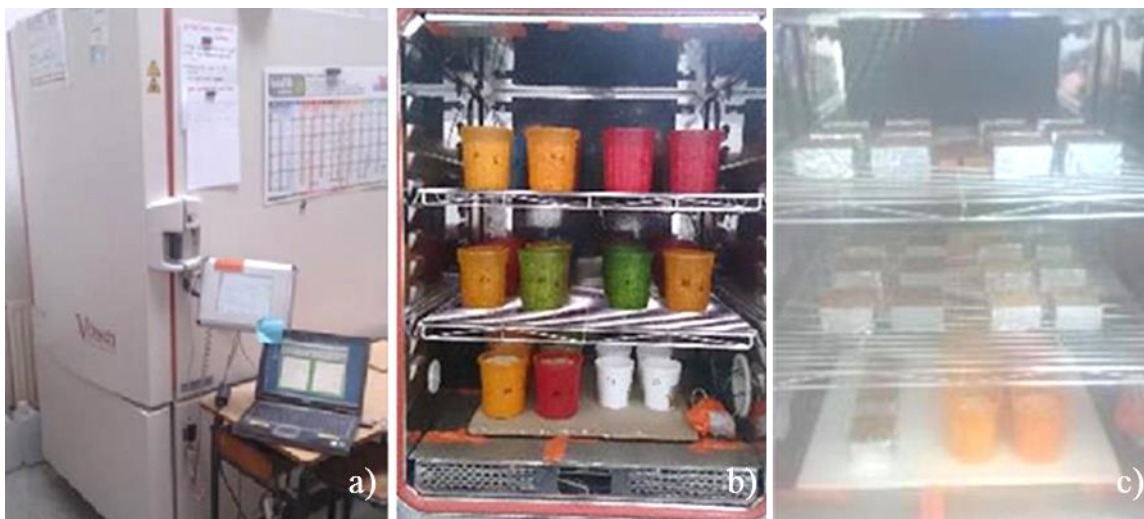
Figure II-11 : Dispositif expérimental pour la mesure de la valeur tampon hydrique.
