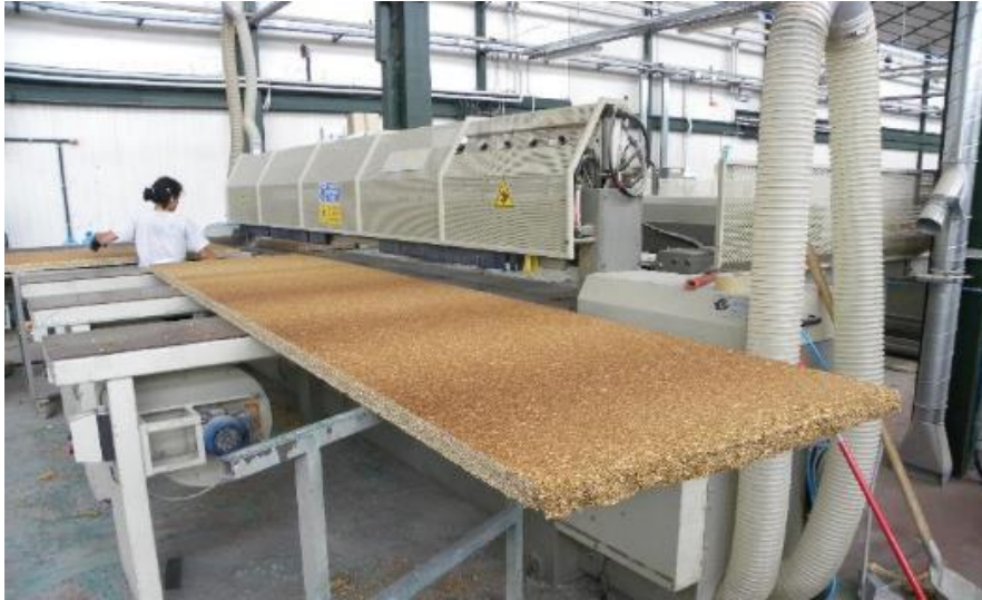
Figure V-23 : Découpe des panneaux aux dimensions finales
