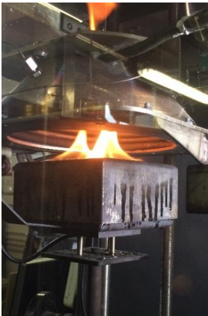
Figure II-21: Chambre de combustion du calorimètre à cône
