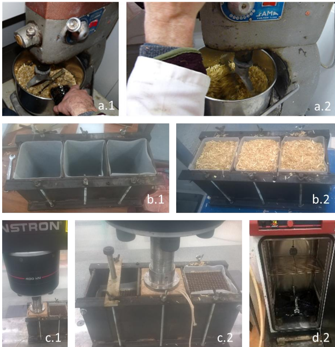
Figure II-6 : Etapes de fabrication des composites 100 mm x 100 mm x 100 mm par moulage
