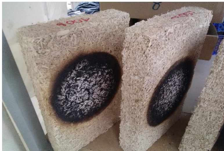
Figure VI-25 : Échantillons C100 après l'essai au brûleur
