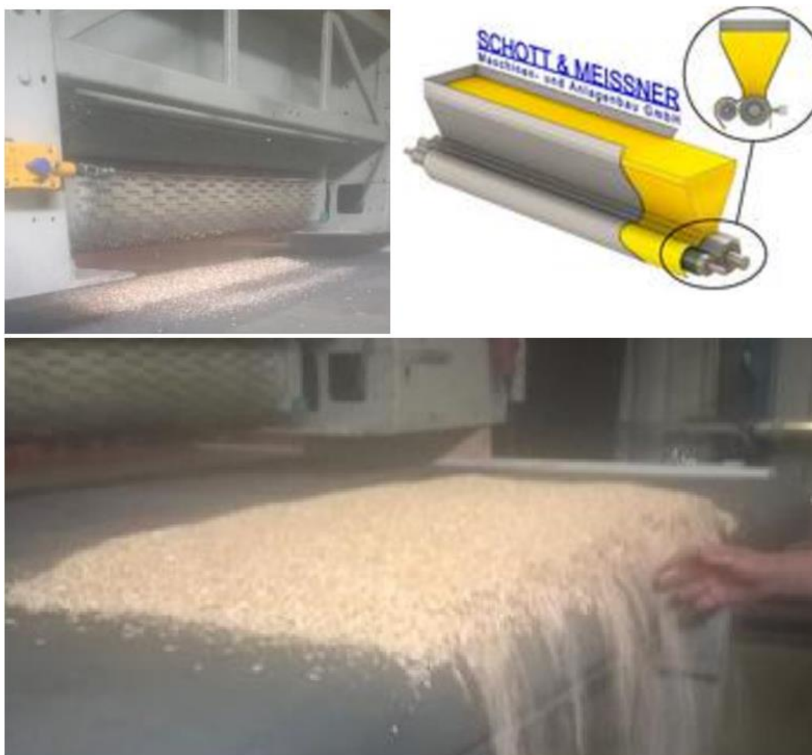
Figure V-2 : Unité de saupoudrage utilisée pour former en continu le mat sur le tapis de convoyage
