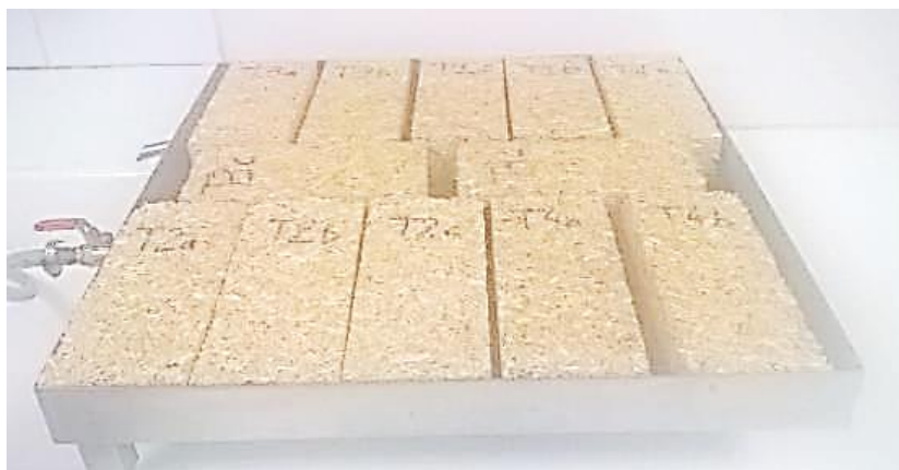
Figure IV-19 : Mesure de l'absorption à l'eau des échantillons par immersion partielle
