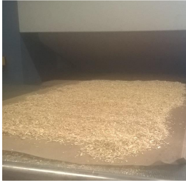
Figure V-7 : Séchage de la chènevotte à l'aide de l'unité de préchauffage
