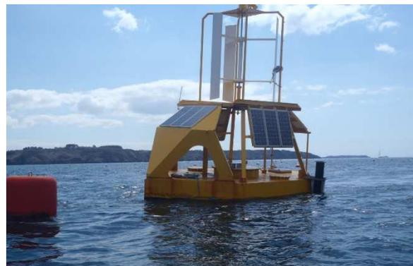
Figure 2.8 : Bouée PH4S installée en rade de Brest. Cette bouée est munie d'un système houlomoteur, d'une éolienne, d'une hydrolienne et de panneaux solaires.
