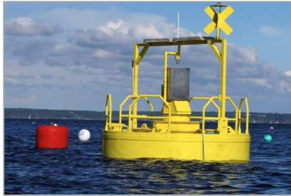
Figure 2.7 : Bouée PB03 installée en rade de Brest. Cette bouée est munie du système houlomoteur et de panneaux solaires.
