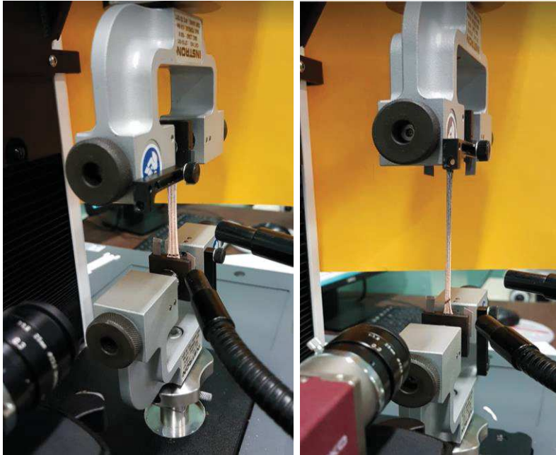
Figure 20 : machine de traction MTS, équipée d'une cellule de force de 100 N
