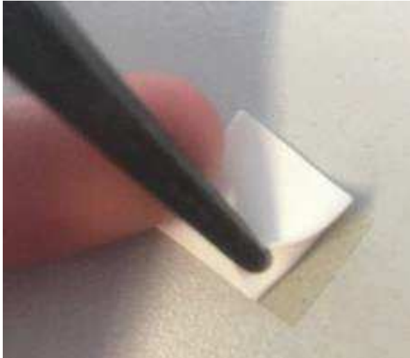
Figure 92 : exemple de délamination entre membrane et film
