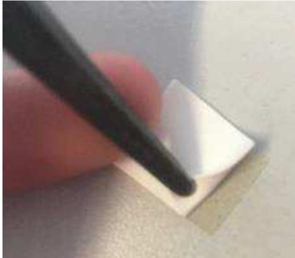
Figure 92 : exemple de délamination entre membrane et film
