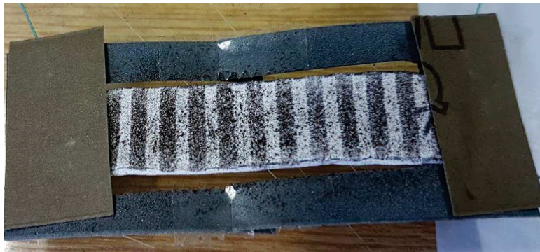
Figure 18 : en haut, méthode de fixation d'une éprouvette pour l'essai de traction uni-axiale (étoiles : points de colle). En bas, photo d'une éprouvette avant traction
