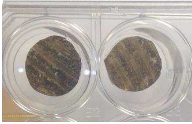
Figure 49 : aspect du Goretex® imprégné en fin d'immersion
