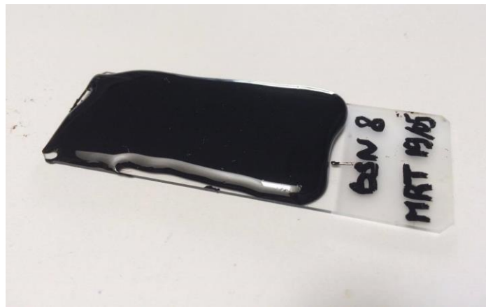
Figure A-2 : Exemple d'échantillon de bitume pour les mesures de tension de surface.
