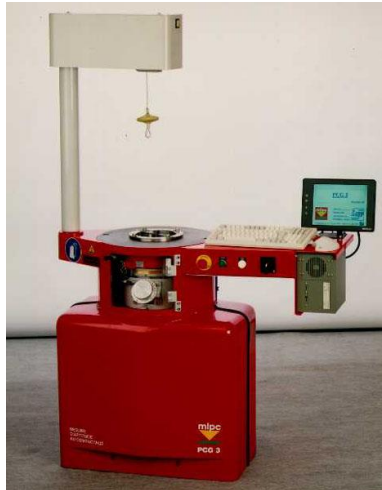
Figure VI-17 : Presse à Cisaillement Giratoire.
