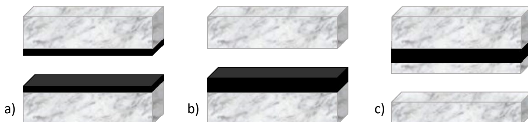
Figure I-7 : Profils de rupture possibles a) cohésive dans le liant b) adhésive à l'interface c) cohésive dans le granulat.
