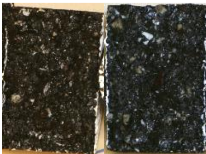
Figure A-15 : Surface de rupture des échantillons en fonction du nombre de cycles de gel/dégel.
