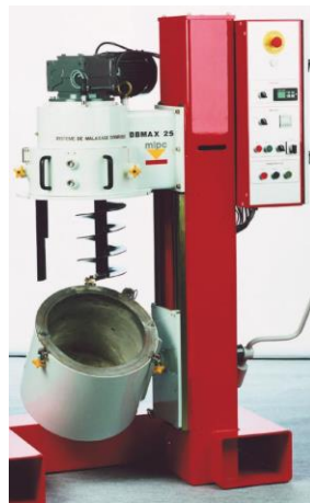
Figure VI-16 : Malaxeur utilisé pour la fabrication des enrobés.
