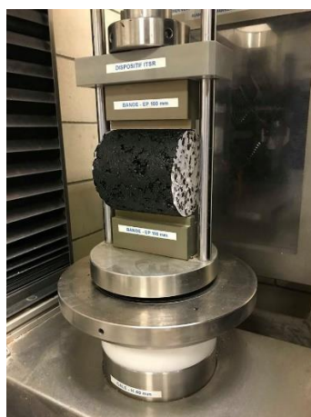
Figure VI-22 : Dispositif essai ITSR.
