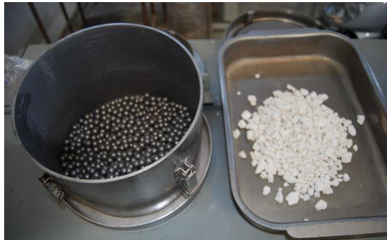
Figure VI-9 : Préparation des échantillons pour l'essai Micro Deval.
