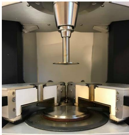
Figure VI-5 : Géométrie cône-plan du rhéomètre.
