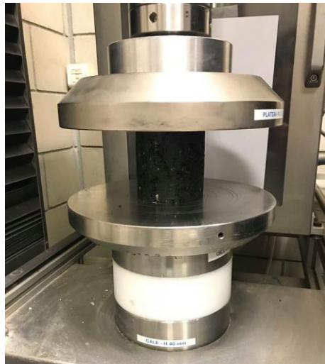
Figure VI-20 : Dispositif Essai Duriez (Compression axiale).
