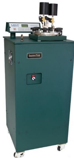
Figure VI-19 : Colonne de saturation pour le protocole MIST.
