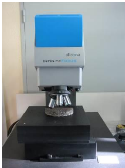
Figure VI-13 : Capteur Infinite Focus pour l'analyse de la texture des échantillons granulaires.
