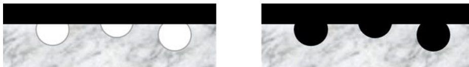
Figure I-9 : Schématisation d'un ancrage mécanique du bitume sur le granulat. A gauche, le bitume est trop visqueux pour pénétrer dans les pores. A droite, le bitume est assez fluide pour mouiller la surface et remplir les cavités.
