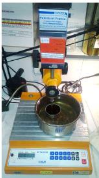
Figure VI-2 : Dispositif expérimental pour mesurer la pénétrabilité à l'aiguille (NF EN 1428).
