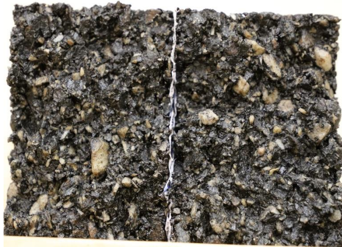
Figure A-28 : Etat de surface de rupture des échantillons conditionnés dans l'eau pour la formule Quartzite/bitume 70/100.
