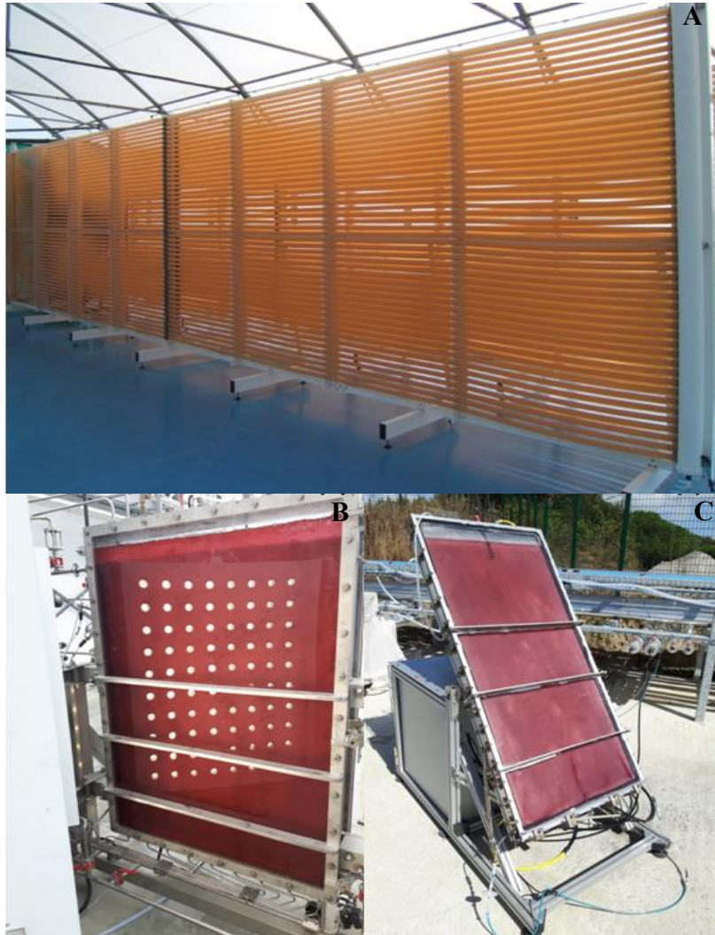
Figure 21 : Cultures de Porphyridium cruentum en (A) photobioréacteur vertical tubulaire (Copyright : Société Greensea, Mèze, France), (B) photobioréacteur plan non incliné en lumière artificielle (Copyright : Algosource Technology, France) et (C) photobioréacteur plan incliné en lumière naturelle (Copyright : Plateforme AlgoSolis, GePEA, Université de Nantes, CNRS) (Gaignard et al. , 2019).
