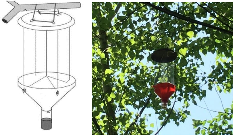
Figure 39. Présentation du modèle de piège polytrap® utilisé, et d'un piège après confection et installation.
