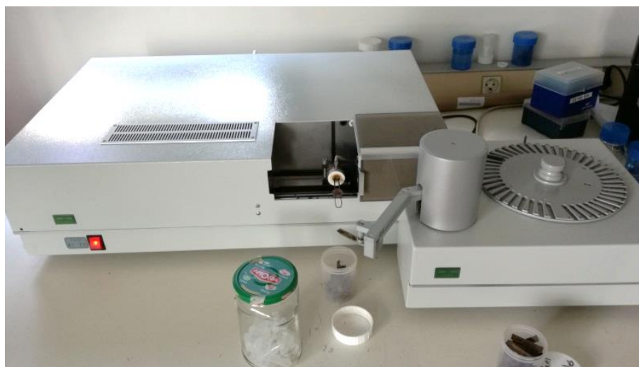
Figure 40. Présentation de l'Analyseur de Mercure Avancé (AMA) 254.
