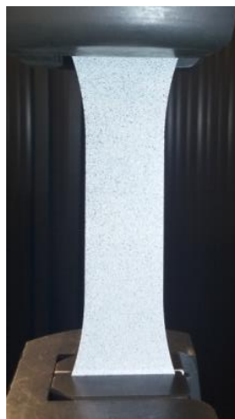
Figure 37 : Eprouvette d'essai pour sollicitation statique dans la machine de traction Instron
