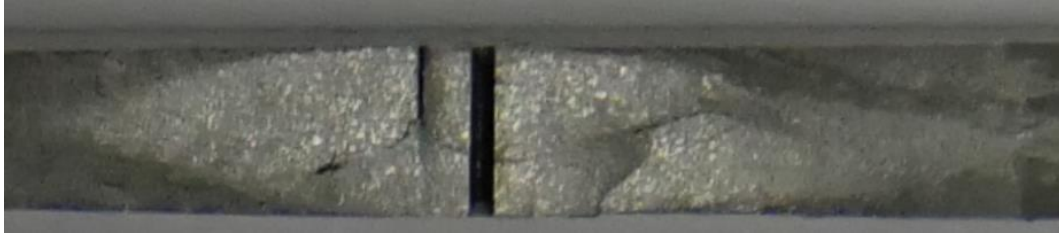
Figure 120 : Exemple de faciès de rupture d'une éprouvette du cas gradient
