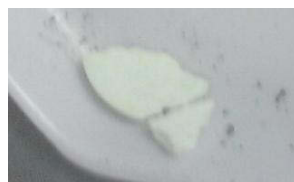
Figure 96 : Aspect de \text{MgF}_2 suite à son immersion dans l' \text{UF}_6 liquide
