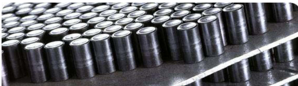
Figure 9 : Pastilles d'oxyde d'uranium prêtes à leur utilisation en centrale nucléaire
