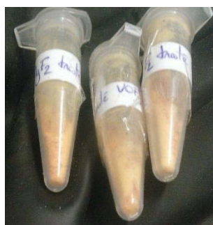
Figure 74 : Aspect des granules de \text{MgF}_2 après leur exposition à \text{VOF}_3
