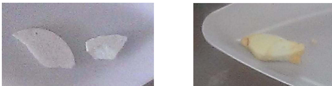
Figure 101 : Aspect du concassé de KMgF 3 avant immersion (à gauche) et après immersion (à droite)
