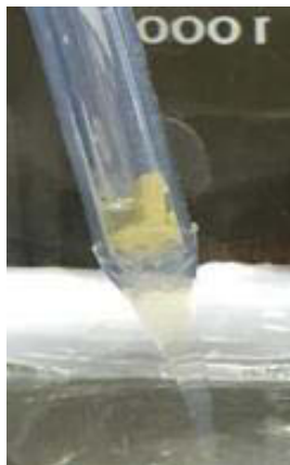
Figure 149 : Aperçu du milieu réactionnel entre l'UF 6 liquide et les oxydes métalliques (ici Al 2 O 3 )
