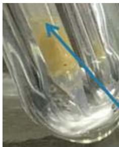
Figure 156 : Aperçu de l'échantillon d'oxyde de bismuth au cours de sa réaction avec l'UF 6 liquide.
