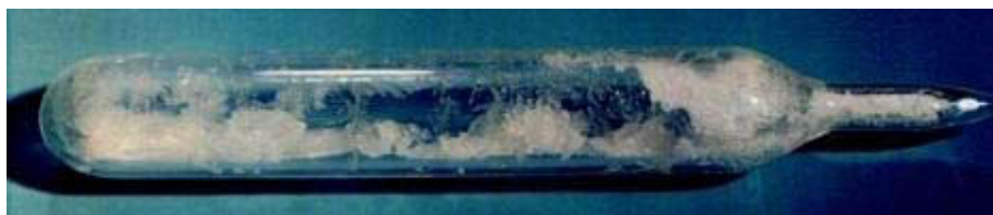
Figure 11 : Ampoule en verre contenant des cristaux d'hexafluorure d'uranium
