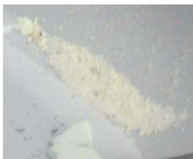
Figure 98 : Aspect du dépôt jaune présent sur les parois suite à l'immersion de \text{MgF}_2 dans l' \text{UF}_6 liquide
