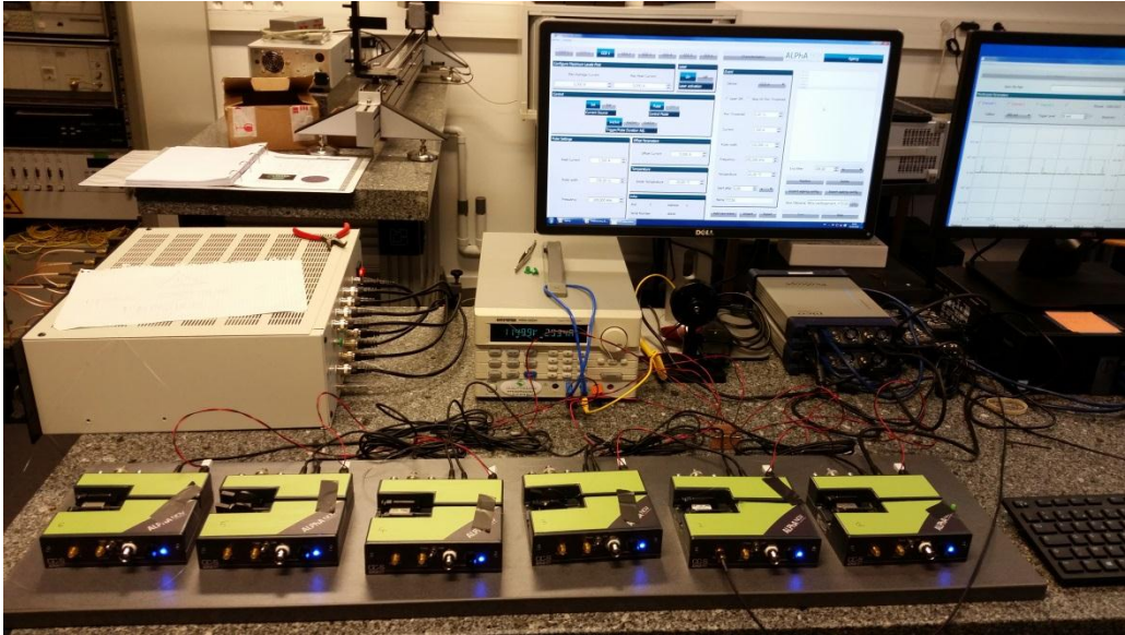
Figure 26 – Banc de vieillissement en régime impulsionnel dans sa configuration définitive
