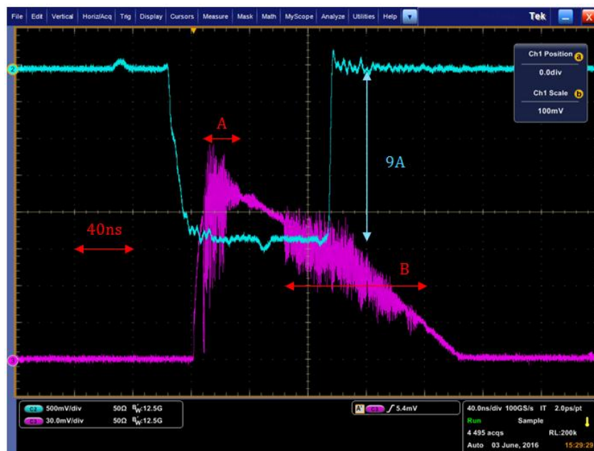
Figure 15 - Oscillations parasites observées sur la réponse d'un module Laser sans FBG (courbe rose). La sortie « current monitor » du circuit PicoLAS est également détaillée (courbe bleue). Le décalage temporel observé entre ces deux courbes provient du temps de propagation de l'impulsion Laser au sein de la fibre optique de la diode
