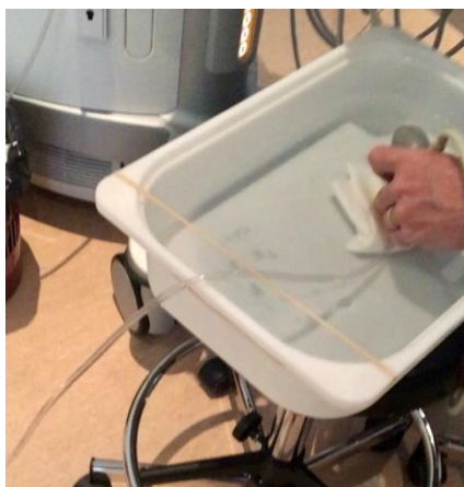
Figure 5-9 : Dispositif utilisé pour la mesure de vitesse par échographie doppler. On distingue le tuyau alimenté par un réservoir contenant de l'eau dans laquelle des bulles d'air ont été intégrées, la sonde de l'échographe est placée au contact du tuyau.
