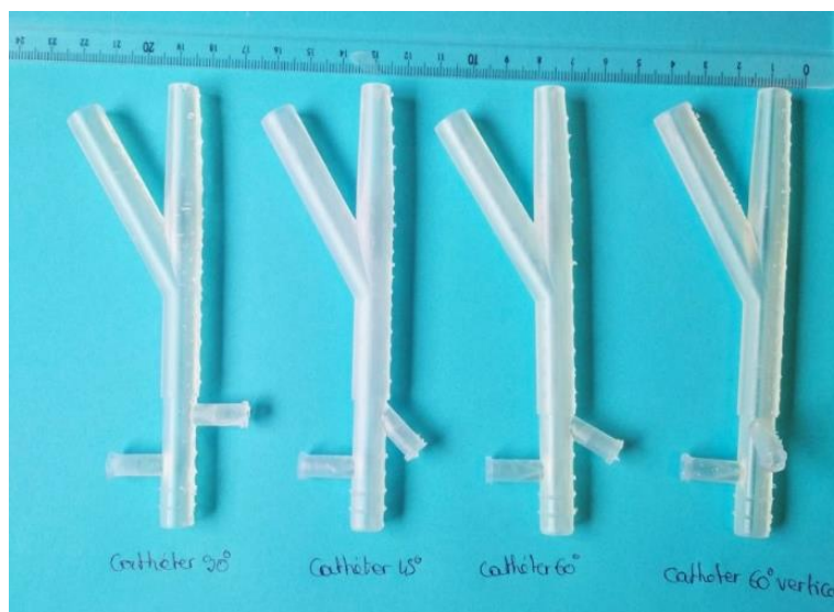
Figure 4-12 : Impression 3D des géométries avec un diamètre interne réduit dans la branche principale, les modèles présentés ont une bifurcation de 30°, le diamètre interne à l'entrée du modèle et dans la branche secondaire est de 6 mm, et le diamètre interne dans la branche principale est de 5 mm. L'entrée du cathéter est placée à différentes positions (de la gauche vers la droite, le cathéter est placé horizontalement à 90°, 45°, 60°, et verticalement à 60°).
