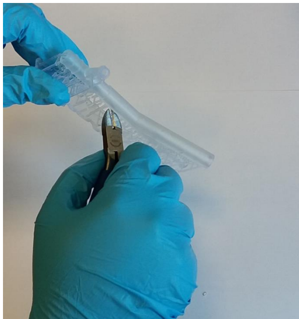
Figure 4-6 : Découpe des supports après impression
