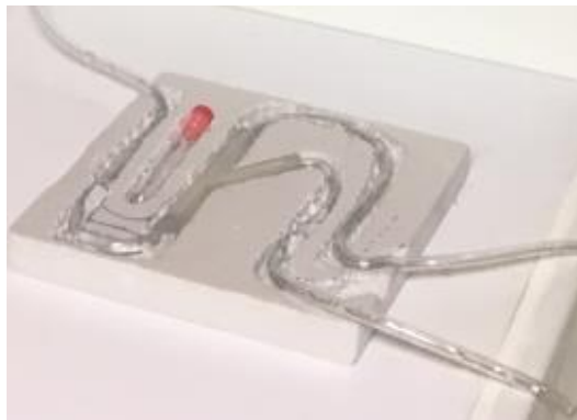
Figure 5-8 : Fantôme de flux utilisé pour la validation de la mesure de vitesse. On distingue le modèle physique à une bifurcation connecté à des tuyaux souples, ainsi que le tube référence (avec bouchon rouge) dans lequel la vitesse est nulle.
