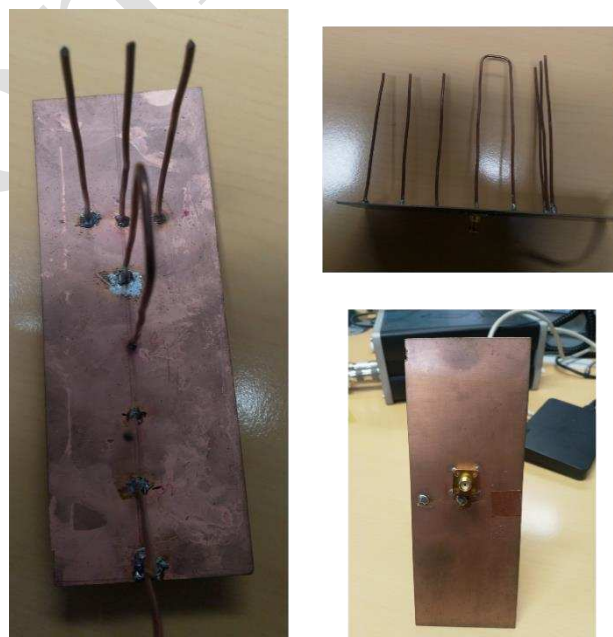
Figure 2.34 Prototype de la solution de TESF avec antenne à faisceau en bout
