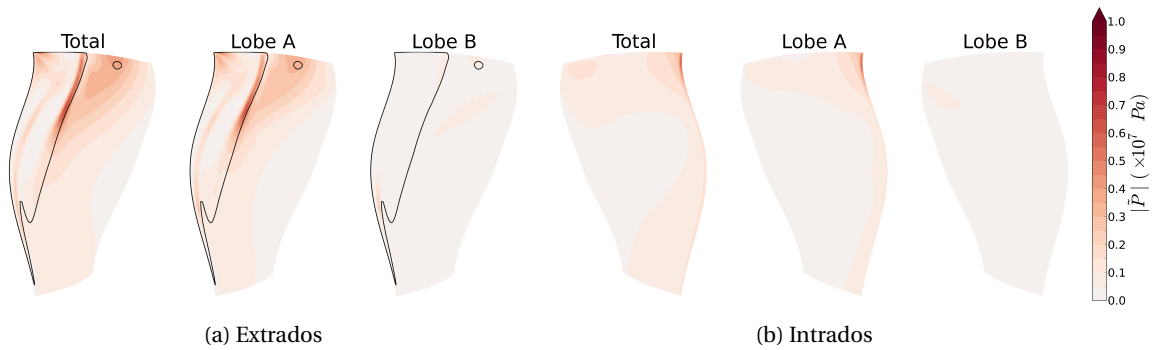
FIGURE 5.15 – Amplitude des fluctuations de pression en fonction de la partie de l’aube en déplacement pour le mode 2ND0 à OP-A
