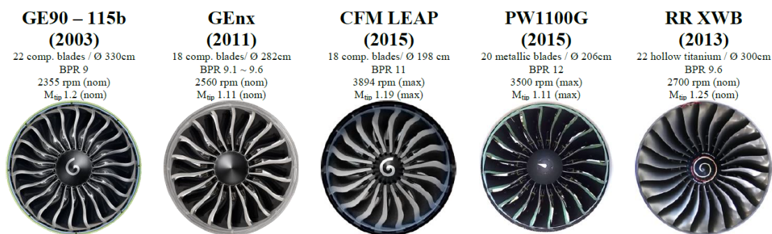
FIGURE 1.3 – Comparatif de fans de turboréacteurs à haut taux de dilution
